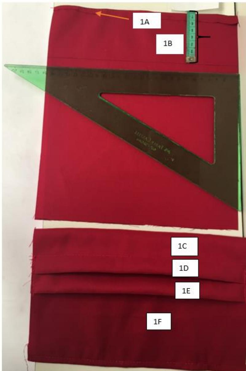
Figuras 1: **1A** - borde superior o inicio, medida a escuadra (90 grados); **(1B)** medida para dobladillo principal de 7 centímetros (doblar a cara posterior) ;**(1C)** dobladillo principal; **(1D)**, **1E**; siguientes dobladillos de 2 centímetros; **1F**, para doblar, 2 centímetros, o sobrante; acabado con dobladillo pequeño o borde inferior.
